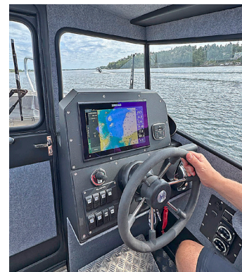
Något hög pulpet framför ratten, men fördelen är att man får in en 12-tums kartplotter. Bra placering av huvudströmbrytarna vid förarplatsen nere till höger.
